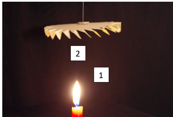
Bild: „Kerze – Nachweis der Konvektion“, Tschakert für SenBJW Berlin, CC BY 3.0 de
