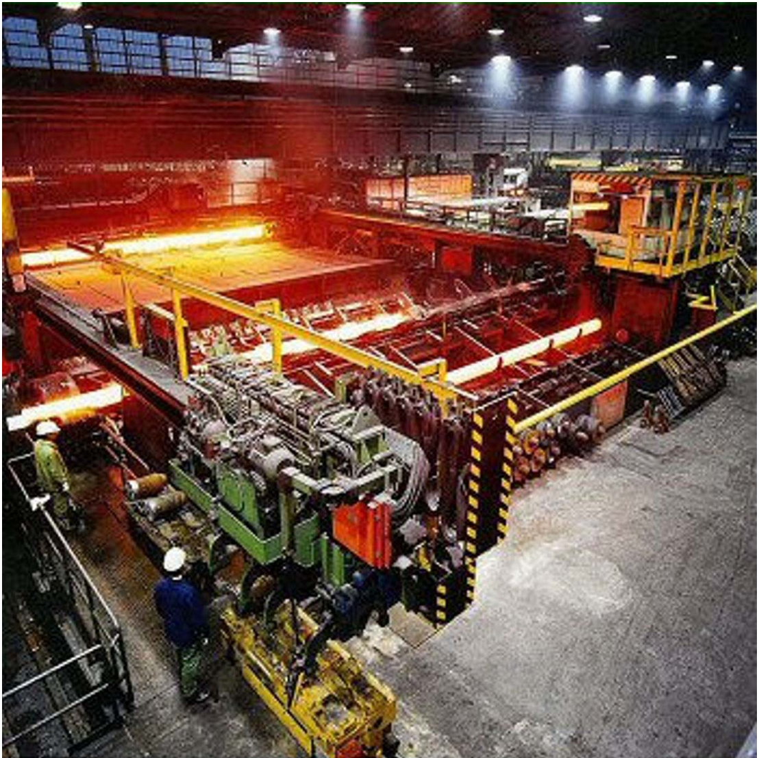
Abbildung 8: Moderne Walzstraße im Rohrwalzwerk Vallourec & Mannesmann 22
